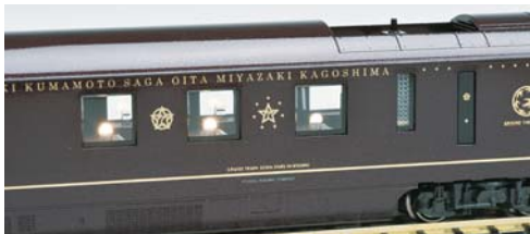
食堂車のテーブルランプが点灯。複雑に配置された妻面の灯火類も実感的に点灯する
